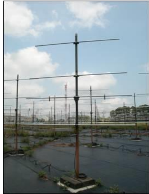
圖 2.3 (a)中壢特高頻雷達全景圖 (b) 52MHz 雷達電離層天線陣列
