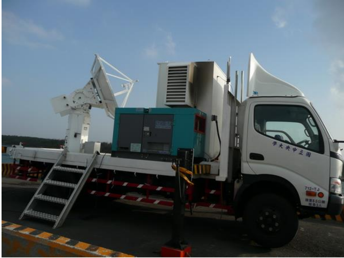
圖 2.1 X 波段移動式雷達(Taiwan Experimental Atmospheric Mobile Radar ,TEAM-R)
